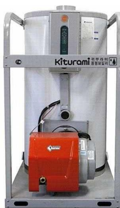
Рисунок 4 – Дизельный двухконтурный котёл Kiturami KSO-100R с параметрами: мощность: 116,3 кВт; отапливаемая площадь: 1000 м 2 ; КПД: 88,1%; диаметр дымохода: 195 мм; напряжение: 220В/50Гц; масса: 350 кг; расход топлива: 45,8 л/сут.
