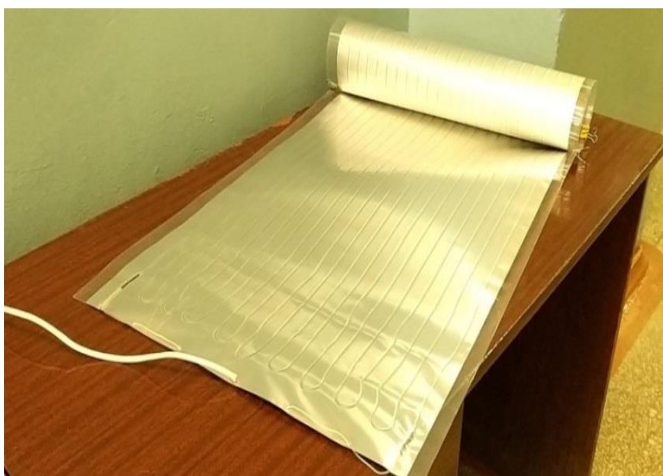
Рисунок 2 – Низкотемпературный пленочный электронагреватель
