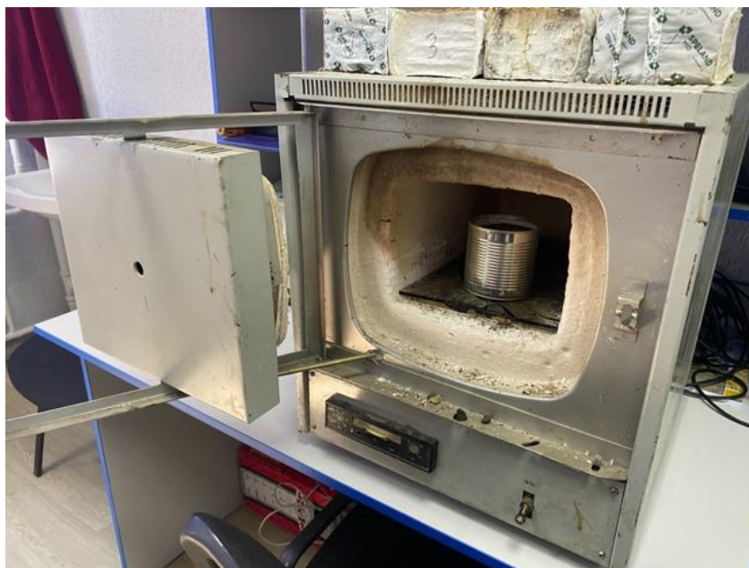
Рисунок 5 – Сушильный шкаф с пробами почвы
