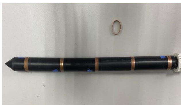
Рисунок 4 – Лабораторная установка для измерения влажности почвы
